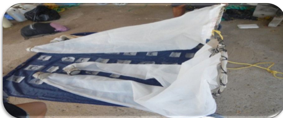
Figura 2. Patín epibentónico utilizado para la recolección del zooplankton demersal en la ensenada de Turpialito, diseñado a partir del modelo de LALLI & PARSONS (2006). (a) Vista frontal del sistema de arrastre, conformado por una red tipo Bongo modificada con cuatro mallas de 300 \mu\text{m} de abertura para la obtención de muestras pareadas. (b) Vista lateral del patín epibentónico utilizado para el muestreo de organismos asociados al fondo marino.
